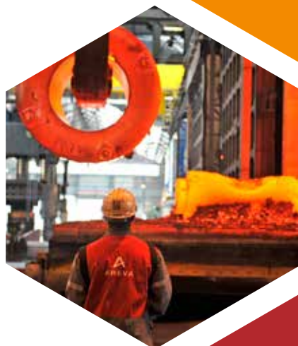
Traitement thermique de la coque d'un conteneur d'entreposage pour le combustible irradié. © Areva
