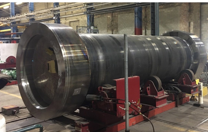
Holtec, fabrication d'un conteneur « tête de série » destiné à Synatom
